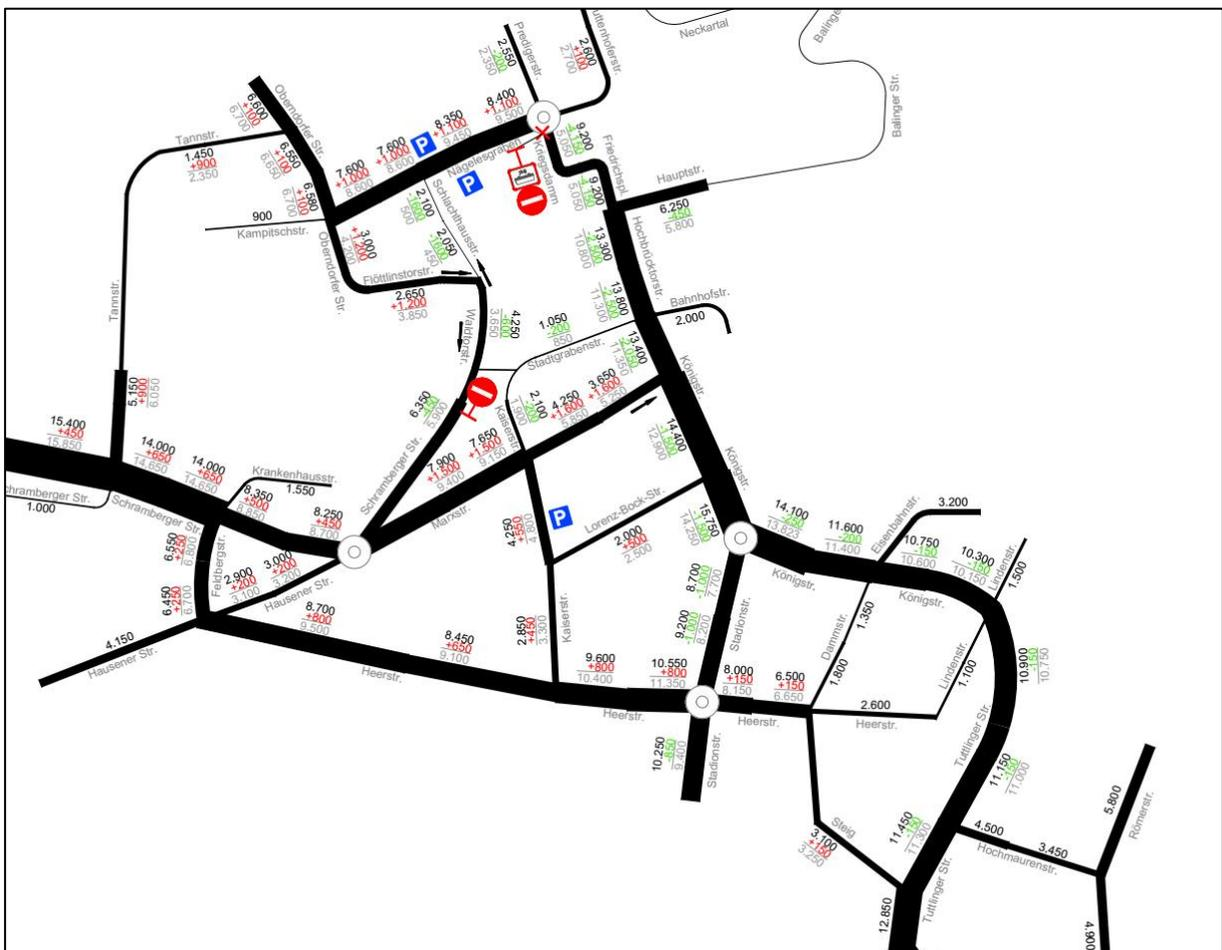
Abbildung 2: Belastungsplan Verkehrsprognose Verkehrsversuch (Bearbeitung und Darstellung: IGV)
