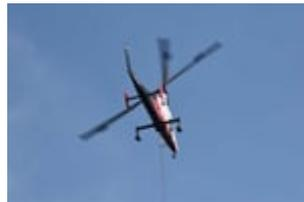
*Der Hubschrauber K-Max K-1200 hat gegenläufige Rotoren.*
