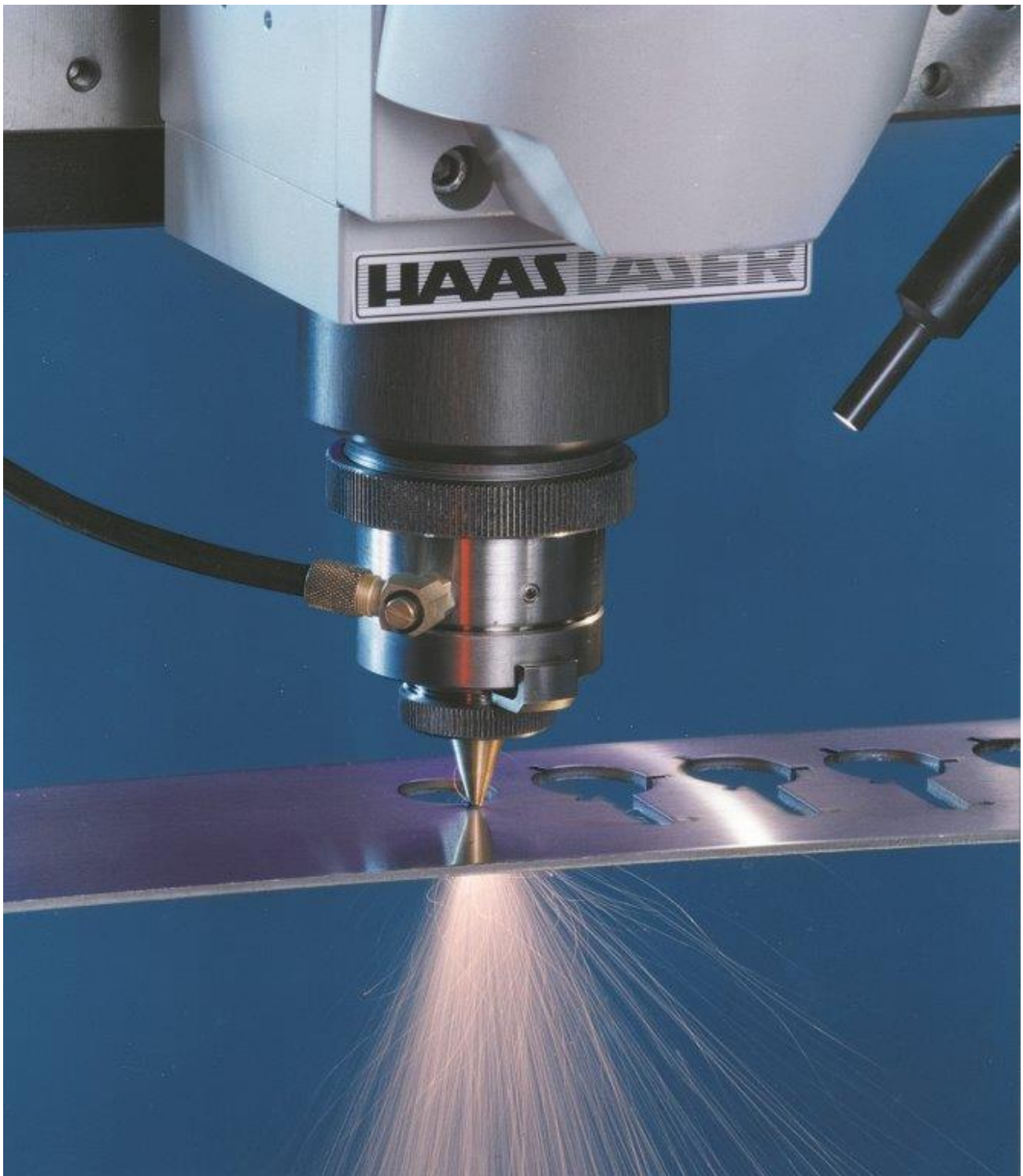
Ein Haas Laser schneidet Stahl. Foto: privat
